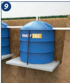
9. Em terrenos arenosos, movediços e lençóis freáticos superficiais, além da base, realizar ancoragem do sistema.
