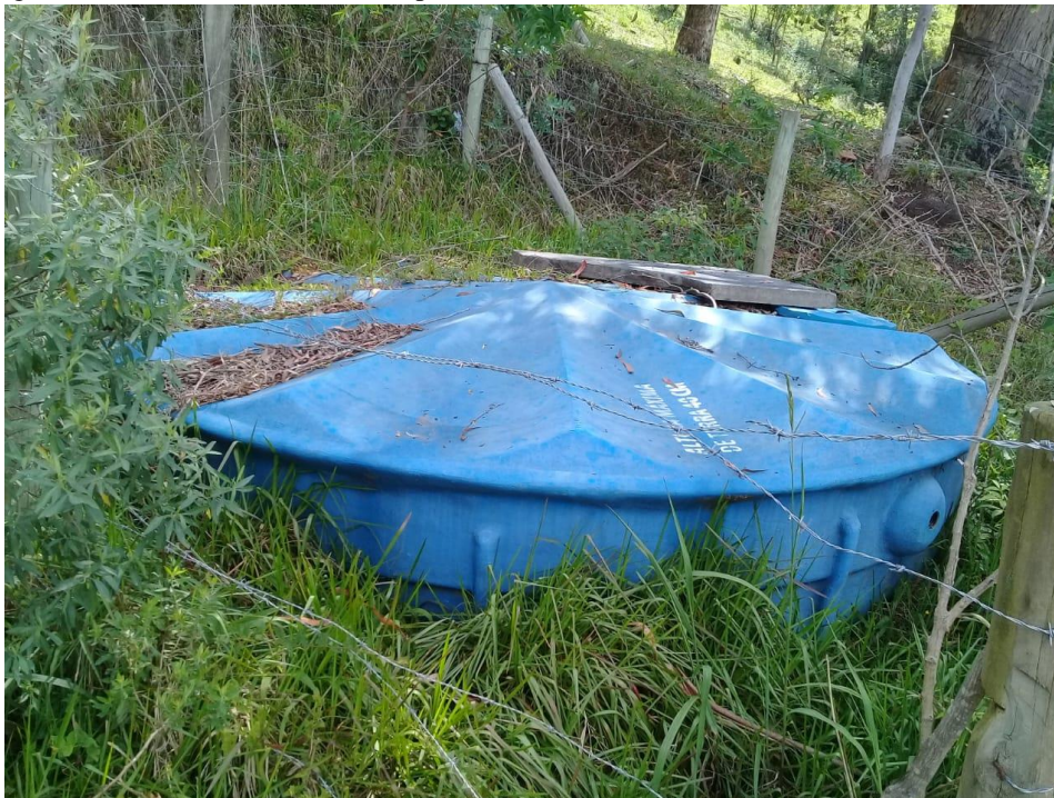
Figura 9 – Caixa de 10 m 3 utilizada para o armazenamento do lodo coletado nas residências.
