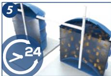
5. Encher com água o Reator e Biofiltro antes de efetuar o aterramento, deixar o sistema em repouso por no mínimo 24h para certificar-se que não haja vazamentos.
