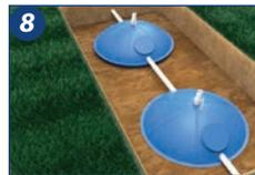
8. Preservar fácil acesso à tampa de inspeção para eventual manutenção e limpeza do equipamento, cuja periodicidade deve ser a cada 12 meses, ou inferior conforme necessidade. Não deve haver atorro sobre a tampa de inspeção, sobre o equipamento o máximo de 30 cm.
