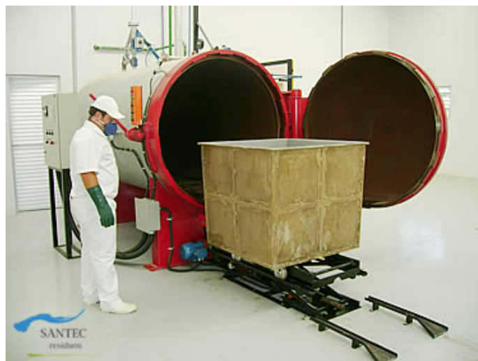
Figura 14 – Processos de esterilização de resíduos da saúde na Santec Resíduos (Içara/SC).
